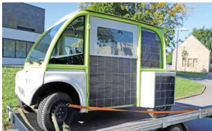
Le prototype de véhicule développé par Eco Solar Breizh : véhicule solaire photovoltaïque + pile à combustible hydrogène
